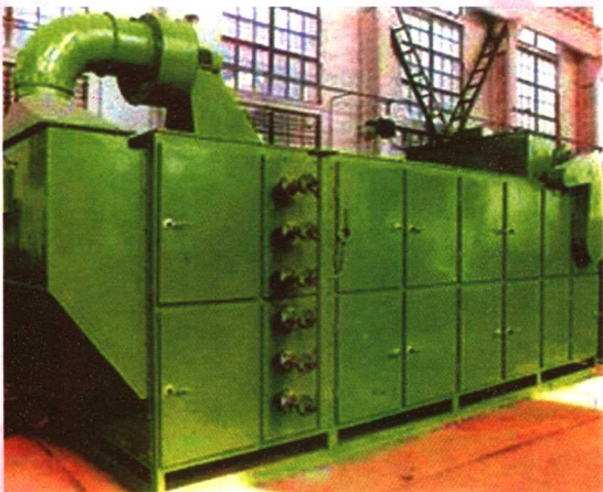
制油中供烘干油茶籽用的 平板烘干机
