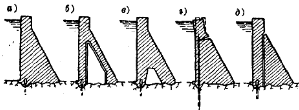
圖 1 混凝土重力壩的型式
