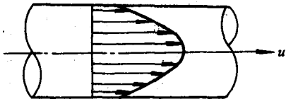
图 1-2 流体在圆管中的流速分布图
