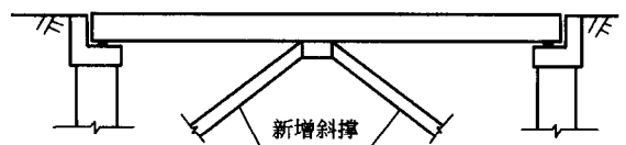
图 1-5 跨中增加支撑变简支为连续
