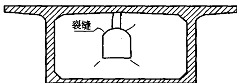
图 1-17 横隔板局部裂缝
