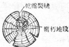
圖9 水份流入乾縮裂縫內的圓木的腐朽
