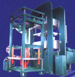
▲XLB(s)-Q1500 \times 1500 \times 2/12 兆牛实芯轮胎硫化机(辅机)
