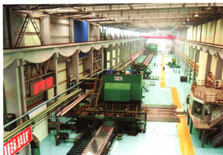
中国第一条代表世界铝加工先进水平的“1+4”热连轧铝材生产线
