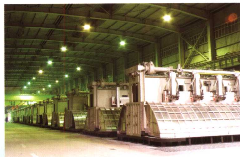
现代大型预焙铝电解工艺及装备技术产业化，为我国淘汰传统自焙槽做出了贡献，在节能环保及资源综合利用方面取得了重大成果
