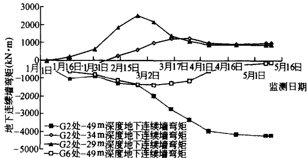
图8 西侧地下连续墙中部不同深度处弯矩随开挖过程的发展情况
