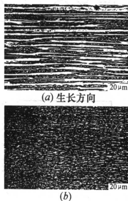
图 8 低氧分压条件下凝固样品的典型微观组织 (a) 以 R = 2.78 \mu\text{m/s} ; T_{\max} = 1250^\circ\text{C} ; p_{\text{O}_2} = 67 \text{ Pa} 生长的亚包晶样品的纵剖面;(b) 以 R = 8.33 \mu\text{m/s} , T_{\max} = 1210^\circ\text{C} , p_{\text{O}_2} = 8 \text{ Pa} 生长的包晶样品的纵剖面
