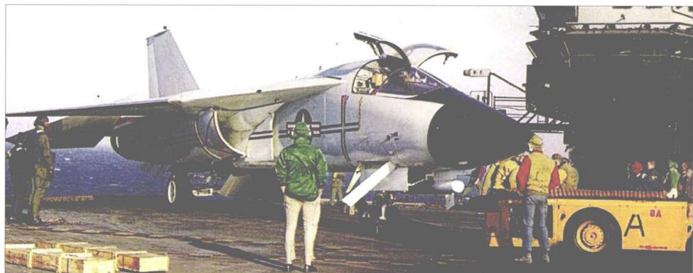
驻泊在航空母舰上准备进行测试的F-111B。在测试过程中该机因结构超重，性能达不到要求，加之导弹火控系统的研制也遇到困难，最后于1968年停止发展，海军取消订单
