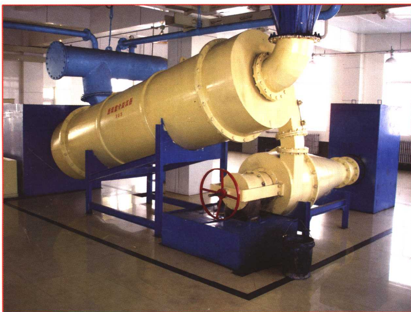
中国唐山国华科技有限公司研制开发的具有中国原创性自主知识产权的FJC系列煤用喷射式浮选机
