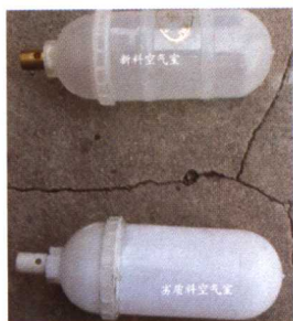
新料和回炉料喷雾器比较
