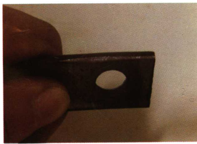
硬度低的锤片锤销几刀后有明显凹陷
