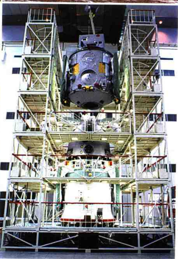
在中国空间技术研究院“神舟”3号飞船进行▶ 整船电性能测试前的轨道舱吊装
