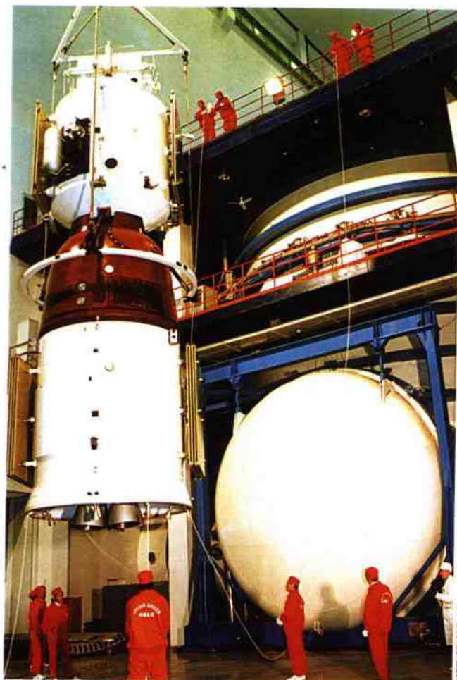
◀ 在中国空间技术研究院“神舟”号飞船与地面设施合练：整船吊入KM6热真空试验罐
