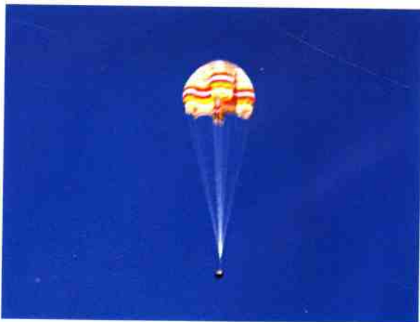
▲ 零高度逃逸救生飞行试验之五：“神舟”号飞船返回舱打开主降落伞，并抛掉防热大底，准备安全着陆
