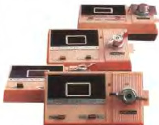
上饒地區糧油機械廠生產的 JCSZ—1 型糧食水份測定儀
