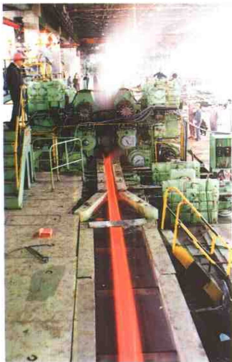
马钢第二轧钢厂H型钢生产线
