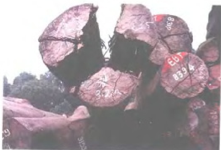
1993年10月,北海商检局检验进口木材,发现内腐、爆裂等严重缺陷。
