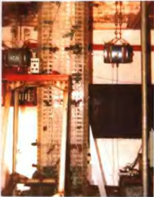
广东国际大厦结构抗震模型试验。
