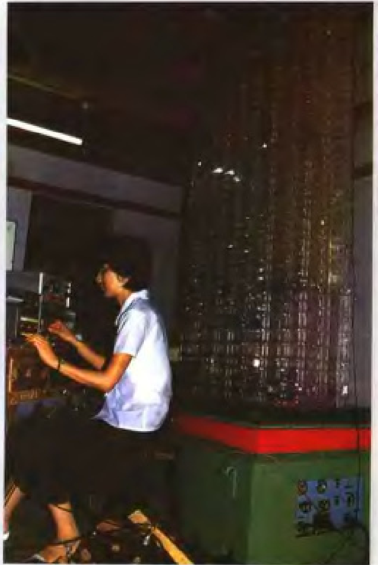
在振动台上进行结构模型试验。
