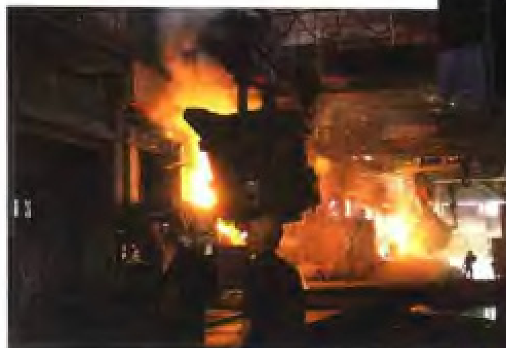
三明钢铁厂氧气顶吹转炉车间
