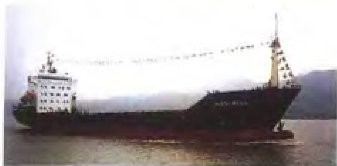
7300DWT级多用途集装箱货轮（B型）
