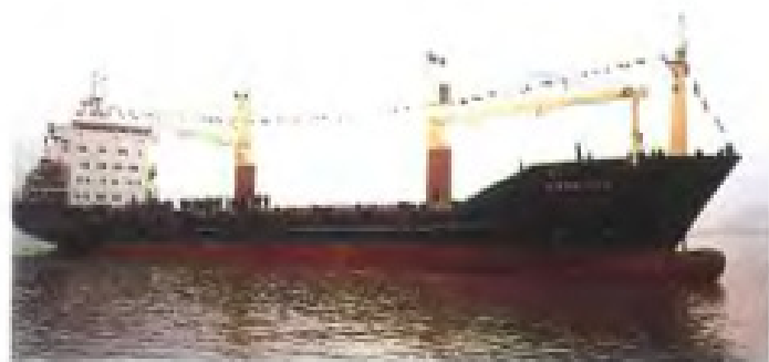
7300DWT级多用途集装箱货轮（A型）
