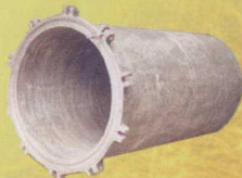
气体渗碳炉炉罐
