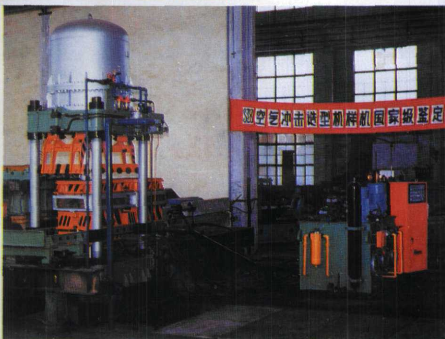
▶ 苏州铸造机械厂 生产的 SZ8 空气冲击 造型机
