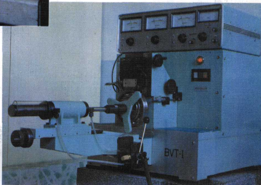
▶ 杭州轴承试验中 心研制的BVT-1型 轴承振动测量仪
