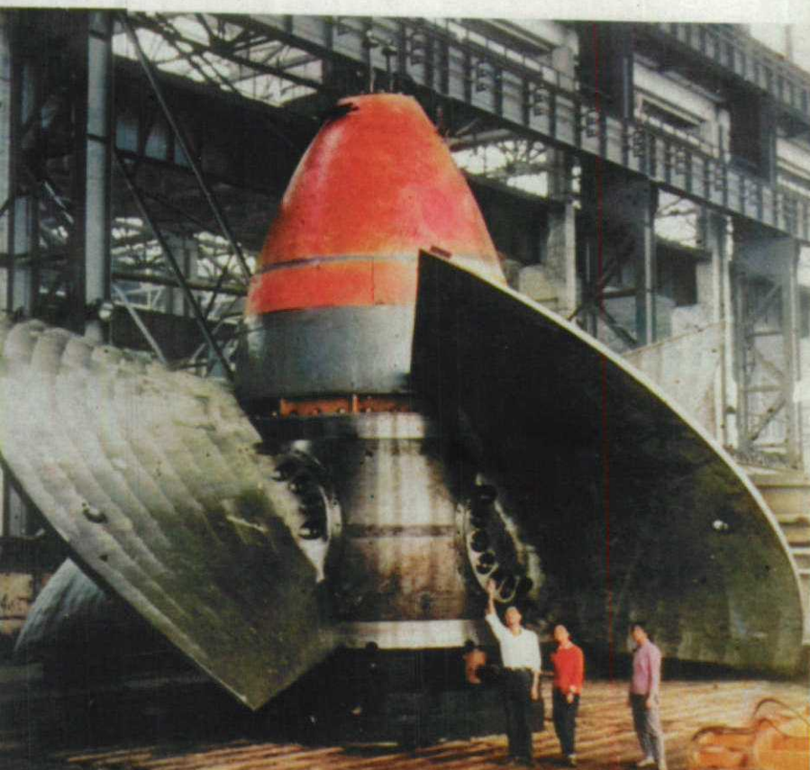
◀ 17万千瓦轴流转桨式低水头水轮发电机组是四川东方电机厂为葛洲坝水电站设计制造的。水轮机转轮直径11.3米，是目前世界上直径最大的转轮。
