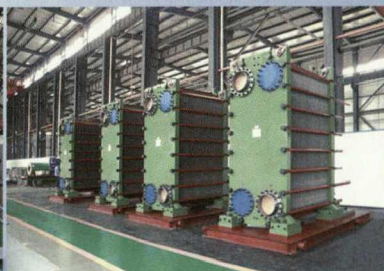
核岛设备——冷热换热器
