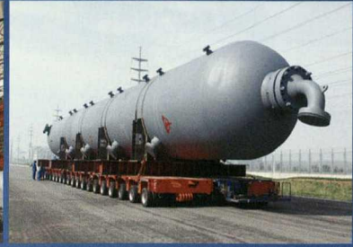
板焊式加氢反应器 (单台重量达837t)
