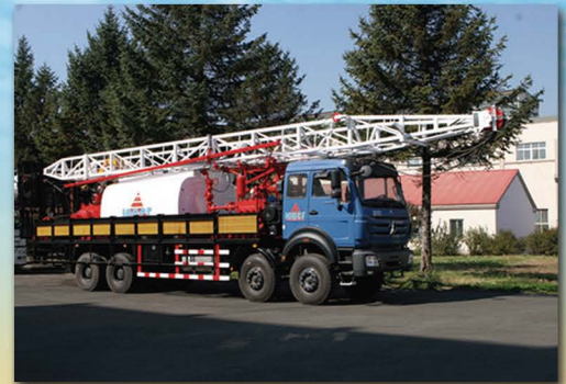
出口哈萨克斯坦的组合冲砂修井机（激励车）
