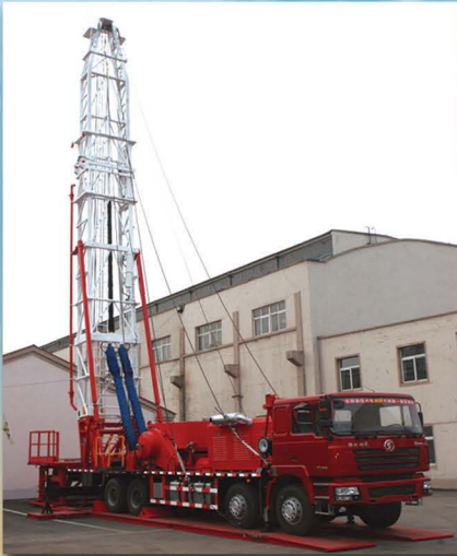
大庆油田需求的二类底盘无绷绳修井机
