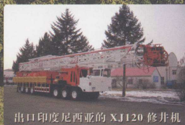
出口印尼和阿尔巴尼亚的液力 30t 修井机
