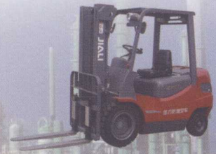
CPCJB/CPCDB内燃平衡重式防爆叉车
