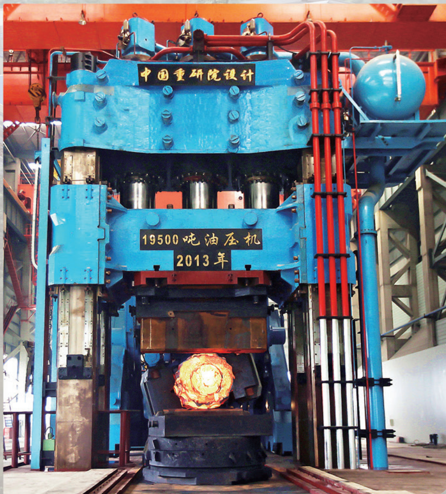
超大吨位（19500t）自由锻造油压机
