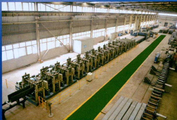
U形槽罗拉生产线
