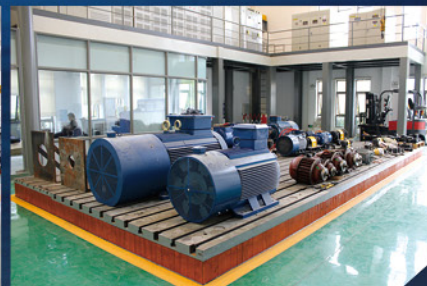
中小型电机性能试验台
