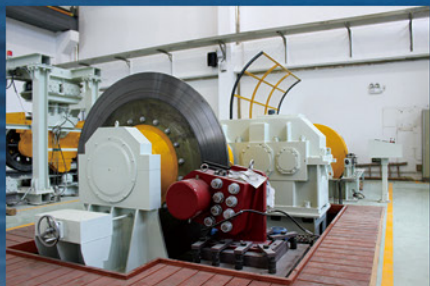
大扭矩安全制动装置动态试验台
