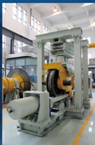
大型港机防风 抗滑装置动态 试验台
