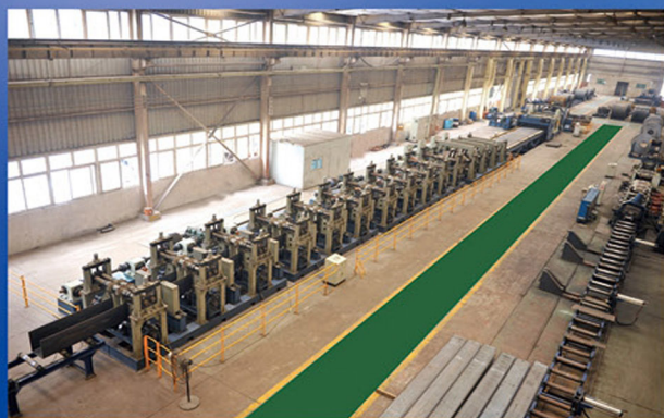
U型槽罗拉生产线
