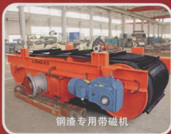
上吸式废钢及冶金渣磁选机
