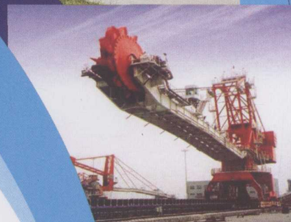
由华电工程设计制造 具有自主知识产权的 斗轮堆取料机
