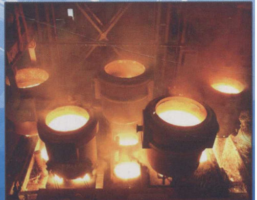
上重正在进行5包合浇453t大型铸件
