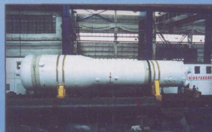
60万kW核电稳压器正在装车发运
