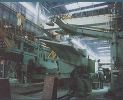
▲为“鞍钢”提供的中间罐车
