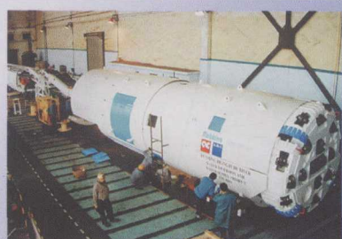
盾构式掘进机组装
