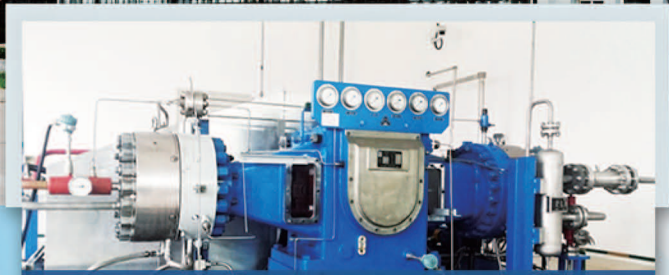
用于某航天发射基地的四台GD4-200/50-450高压氮气隔膜压缩机
