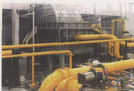
↑ P275/8-N 盘式真空过滤机，2001 年通过上海市新产品鉴定，规格与技术水平属国内领先。
