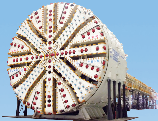
南京市纬三路过江通道工程 开挖直径 15.03m 泥水气压平衡复合式盾构机
