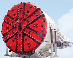
珠海城轨 Φ 8780mm 复合式土压盾构机
