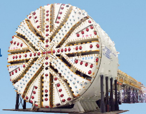
Φ8280mm核电站排水管道盾构机
