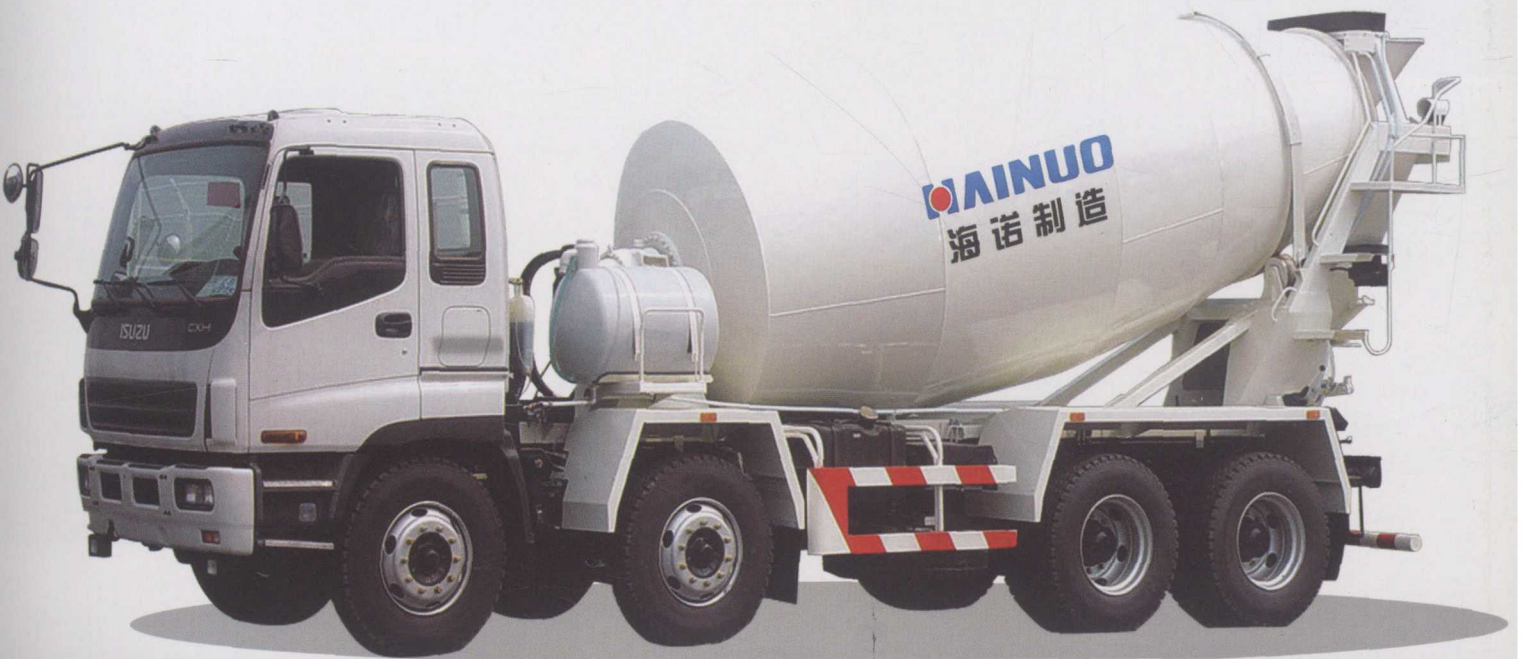
混凝土运输车
