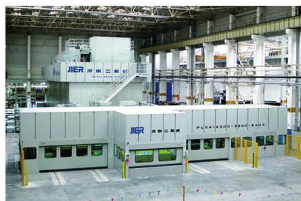
为烟台通用东岳汽车公司提供的自动化双臂快速冲压线
