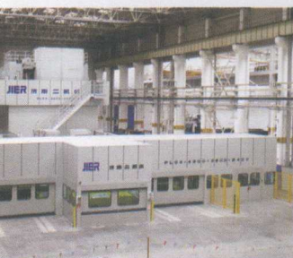
为上海通用东岳汽车公司提供的自动化双臂快速冲压线
