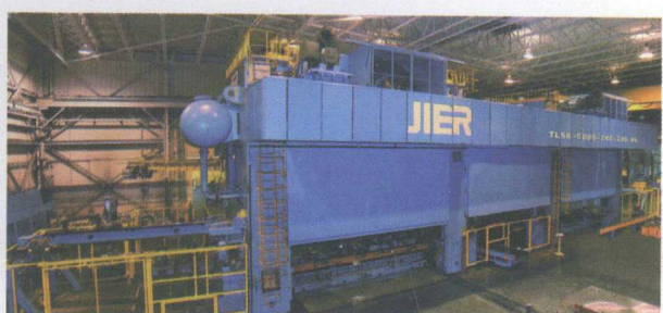
出口美国的50 000kN重型多工位压力机
