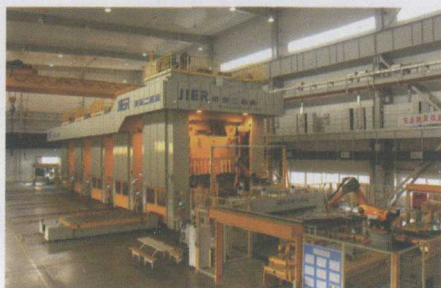
为南京南汽模具装备有限公司提供的机器人自动化冲压线
