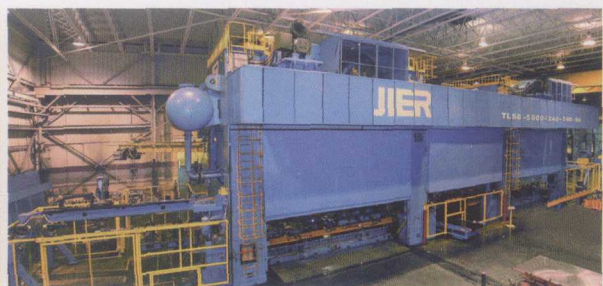
出口美国的50 000kN重型多工位压力机
