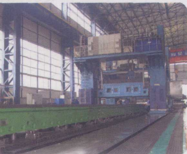
填补国内空白的40m重型 数控龙门移动式镗铣床
