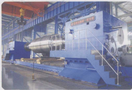
填补国内空白的4.2m数控超重型卧式车床
