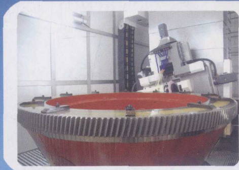
4m数控成形磨齿机在2010年南京机床展览会上获得“春燕奖”，是齐重数控装备股份有限公司通过自主创新，独立研发制造的又一具有自主知识产权的高精尖产品
