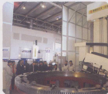
填补国内空白的5m数控 高精度滚齿机
