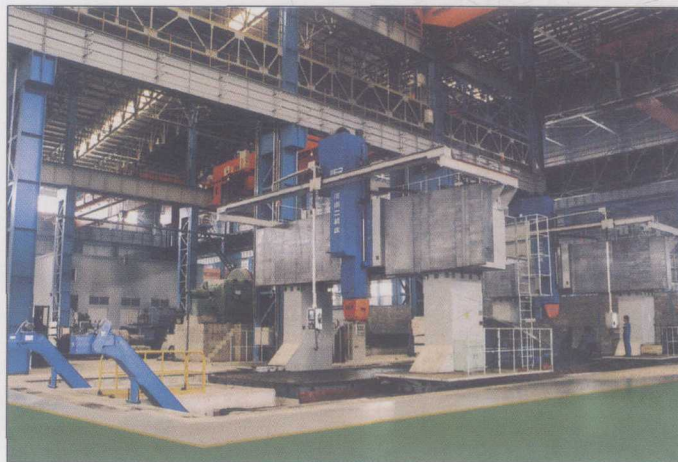
● XKV2745A型机械式五轴联动定梁双龙门移动数控镗铣床，该数控机床填补了国内机械式五轴联动数控镗铣床的空白，不但满足了国内发电、船舶、军工、重型机械、模具等行业的需求，而且摆脱了对国外同类产品的依赖（安装在鞍钢重型机械有限责任公司）
