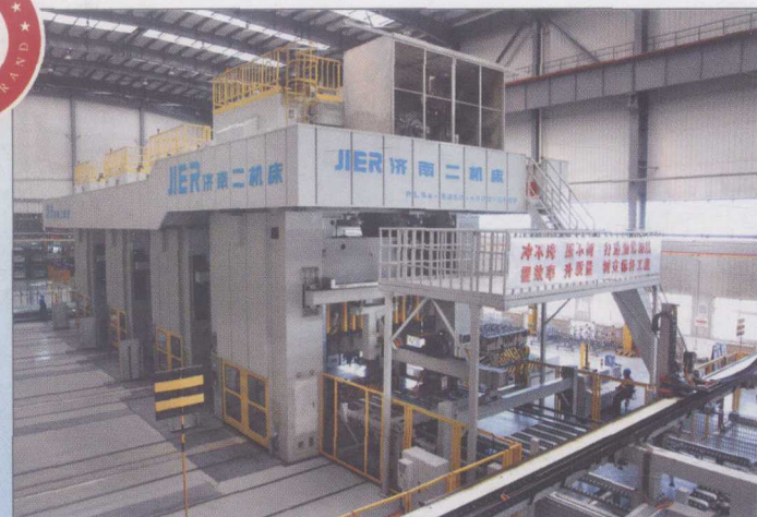
● 由1台LS4—2250/1型、3台JF39—1000C/2型闭式四点单动压力机和快速送料系统组成的大型全自动化快速送料冲压生产线（安装在上汽通用五菱汽车股份有限公司青岛分公司）
