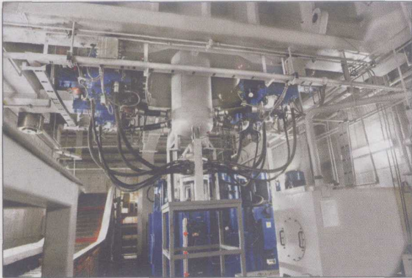
● 具有当今国际先进技术水平的数控液压拉伸垫（拉伸力4500kN）
