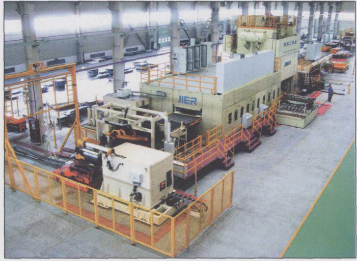
● 由1台J39C-800A型封闭式四点单动落料压力机和开卷、校平、送料、磁性码垛等自动化装置组成的ZSK-2.5 × 2000开卷校平落料自动线(安装在安徽江淮汽车股份有限公司)。
