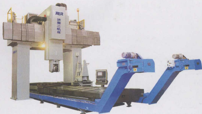
XKV2420A型五轴联动数控定梁龙门镗铣床。系国家“863计划”中高、精、尖数控机床研制项目之一，主要用于国家重点工程“南水北调”中的大型水泵叶片的数控加工。
