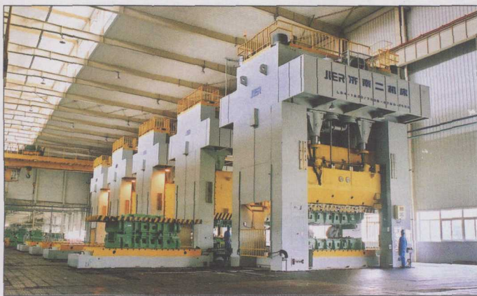
安装在奇瑞汽车有限公司的大型冲压生产线；该公司现拥有济南二机床提供的20条大型冲压生产线（近200台各种压力机组成）；均系国家“863计划”中“汽车工业所需大型自动化冲压生产线的开发研制项目”。
