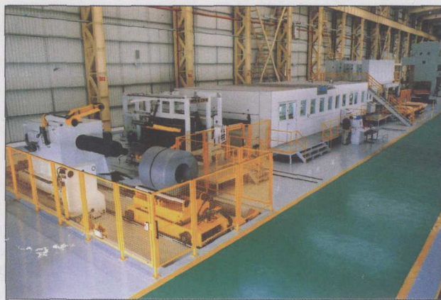
济南二机床集团与德国ANDRITZ/SUNDWIG公司合作生产的ZP-1.5×1800高性能开卷校平剪切码垛自动线。
