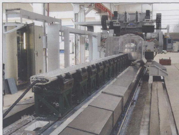
XHF2707型龙门移动式仿形复合加工中心。该数控机床主要用于军用飞机的大梁加工，系国家“863计划”中高、精、尖数控机床研制项目之一。
