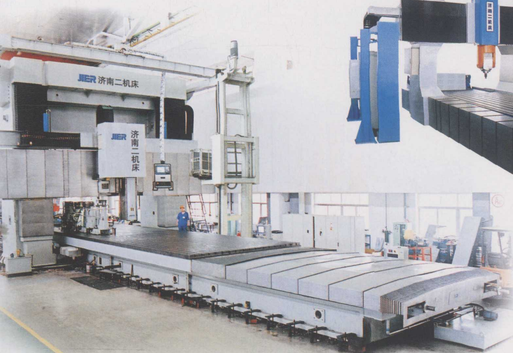
● XK2145型数控动梁龙门镗铣床是目前国内同类数控机床中规格参数较大、技术新的重型数控机床
