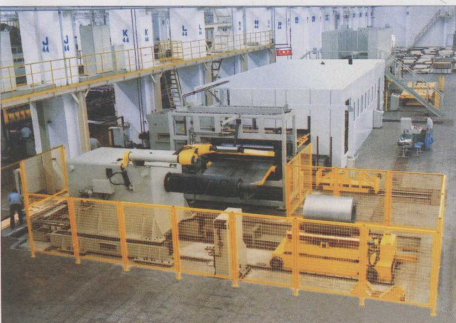
● 与德国著名的科勒尔公司合作生产的ZSK-3×2000高性能开卷校平剪切码垛自动生产线
