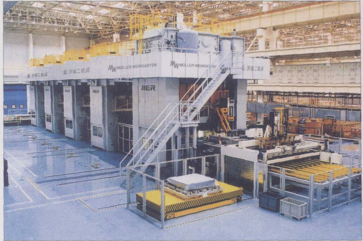
● 由1台LS4—2000型、4台JB39—1000B型闭式四点单动压力机和冲压自动化系统组成的大型自动化冲压生产线（安装在上海通用东岳汽车有限公司）。
