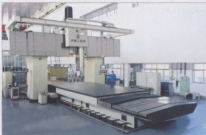
● XK2440×80型数控定梁龙门铣床是目前国内同类数控机床中规格技术参数较大、技术新的重型数控机床。
