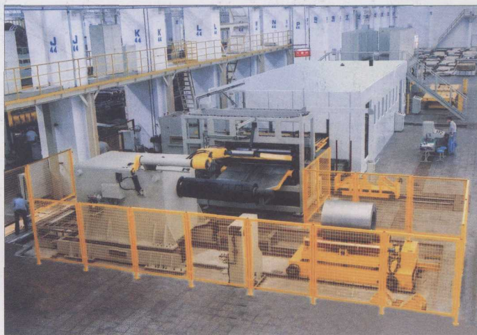
● 与德国著名的科勒尔公司合作生产的ZSK—3×2000高性能开卷校平剪切码垛自动生产线（安装在奇瑞汽车有限公司）。
