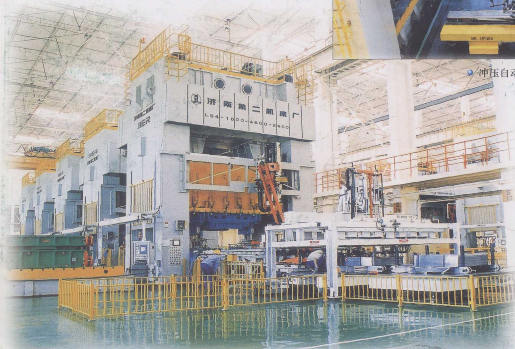
● 由1台LS4—1600型、4台JA39—800型闭式四点单动压力机和冲压自动化系统组成的大型自动化冲压生产线（安装在哈飞汽车股份有限公司）。
