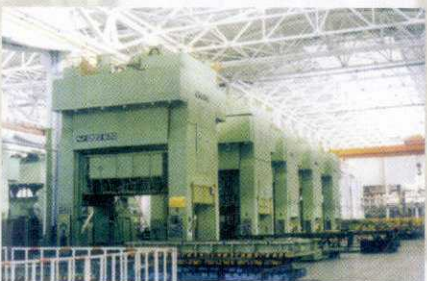
为东风汽车公司轻型车厂成套引进的冲压生产线
