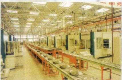
为天津“夏利”轿车厂组织成套设备壳体柔性加工生产线
