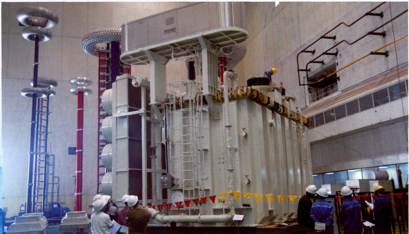
2017年，为广西防城港核电二期“华龙一号”工程研制成功的500kV 450MV·A主变压器
