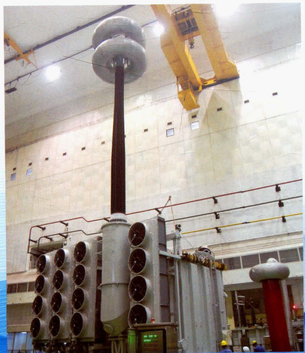
2017年，为陕西能源赵石畔煤电有限公司雷龙湾电厂2×1000MW工程研制成功的1000kV 400MV·A单相发电机升压变压器
