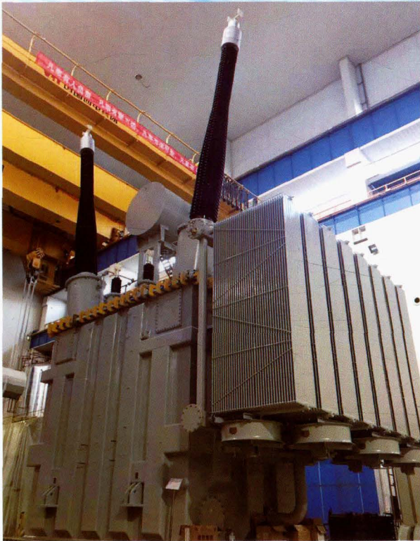
2017年，自主研发成功国际领先的500kV 100MV·A串联变压器
