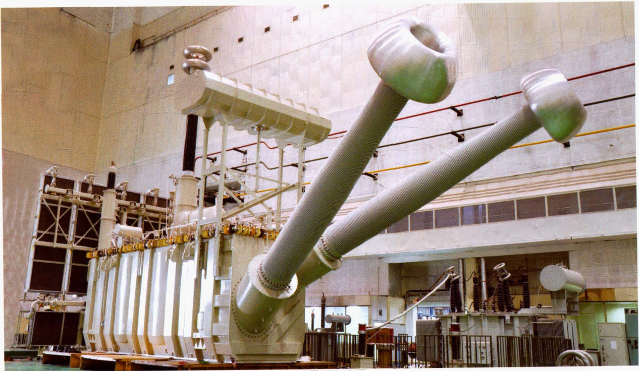
2017年，为上海庙—临沂±800kV特高压直流工程研制成功的509.3MV·A换流变压器
