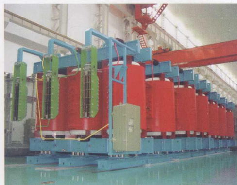
大容量环氧树脂浇注干式电力变压器
